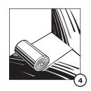
ausreichend (siehe Abb. 4). Außerdem muss unter der Unterlage eine Dampfbremsfolie (z. B. Baufolie) angebracht werden. Die Nähte müssen gut geschlossen sein. Die Folie ist bis hinter die Fußbodenleiste und in Höhe der Fußbodenleiste anzubringen.
