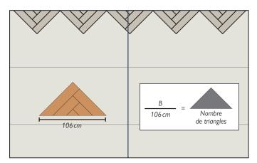
6 Pour déterminer le nombre de triangles nécessaires, vous aurez besoin de la largeur totale du côté d'installation. Divisez cette largeur par 106 cm (le côté le plus long du triangle).
