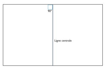
Déterminez (du point de vue du mur de départ) le centre de la pièce. Utilisez un cordeau à craie pour créer une ligne perpendiculaire au mur de départ et tendez-le fermement. C'est la ligne centrale.
