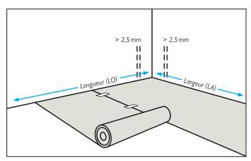
4 La sous-couche autoadhésive peut être facilement découpée à la taille souhaitée à l'aide d'un cutter. Placez la sous-couche le long de la largeur (L) de la pièce, avec le film protecteur vers le haut. Assurez-vous qu'il y a un espace de 2,5 mm entre la sous-couche et le mur. Pour éviter que la sous-couche ne bouge, fixez les bandes ensemble avec du ruban adhésif.
