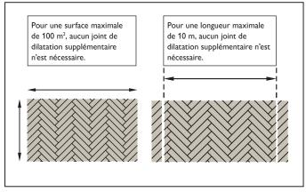
La surface maximale à installer est de 100 m². La longueur maximale de la surface du sol qui peut être posée dans une seule direction est de 10 m. Pour une surface supérieure à 100 m² ou une longueur supérieure à 10 m, une joint de dilatation supplémentaire est nécessaire. De plus, toutes les joints de dilatation le long des murs doivent être augmentés de 5 mm.
