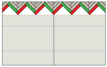
Il y a un maximum de 10 minutes pour déplacer les lames mal installées. Cependant, ne le faites pas trop souvent (pas plus de 2 fois), car cela réduit la qualité adhésive de la sous-couche. Ne chargez pas ou ne mettez pas de poids sur les lames immédiatement après l'installation. La ligne médiane doit toujours être visible. Veillez à ce que la rectitude (la ligne pointillée orange) reste droite par rapport à la pièce.
