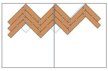
Placez les lames attachées contre le mur de départ, avec les pointes alignées sur la ligne centrale, comme indiqué sur l'image à côté. Vérifiez si tous les coins sont à angle droit et si la distance jusqu'au mur de départ est constante.
