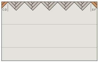
Remplissez des deux côtés. Coupez les distances C-D et E-F du dernier triangle, puis placez-le. Les pièces en PVC Dryback peuvent être facilement découpées à la taille souhaitée à l'aide d'un cutter.
