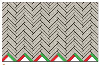
Poursuivez la pose sur l'ensemble de l'espace de cette manière. Après 30 minutes d'installation, le sol peut être légèrement chargé. Cela permet de s'agenouiller sur le sol pour installer d'autres éléments en PVC Dryback.
